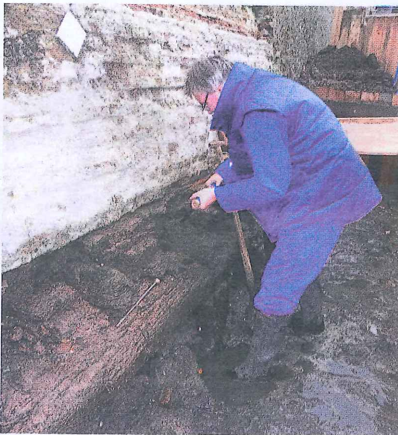
Het boren van een monster uit een houten fundering. Foto: F30
